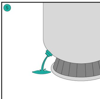
Dévisser le bouchon de vidange du filtre pour évacuer l'eau contenue dans le filtre. Il est conseillé d'évacuer l'eau au fur et à mesure avec un aspirateur, une baignoire ou un tuyau pour éviter une « inondation » du local technique.
