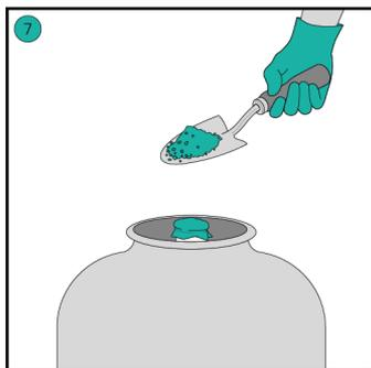
Boucher provisoirement à l'aide d'un chiffon la tête du tuyau présente en haut du filtre. Cela permettra d'éviter d'obturer les crépines en fond de filtre avec du sable qui pourrait s'introduire par ce tuyau.
