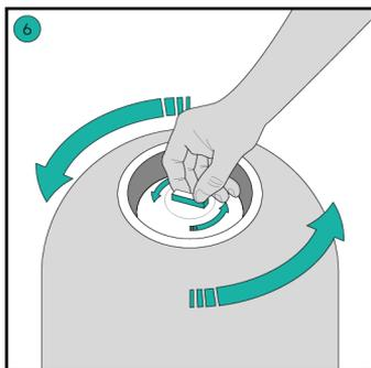
Dévisser le diffuseur d'eau (s'il existe), ce qui permettra d'accéder à l'intérieur du filtre plus facilement.
