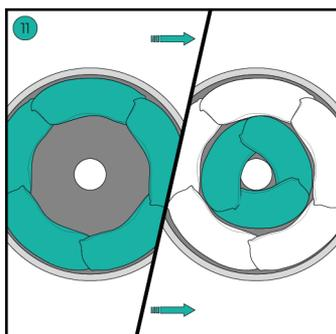
Les **SANDBAG**<sup>®</sup> sont à disposer en escargot au-dessus du sable grossier (gravier) en commençant par les BLEUS. A la main, aplatir les sacs afin de favoriser le recouvrement entre sacs sur leur longueur et sur leur largeur.
