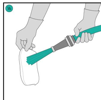
Quand vous le souhaitez, au moins une fois par an, enlever les couches supérieures de SandBags<sup>®</sup> et les nettoyer au jet d'eau (pas de jet sous pression, pas de Kärcher)
