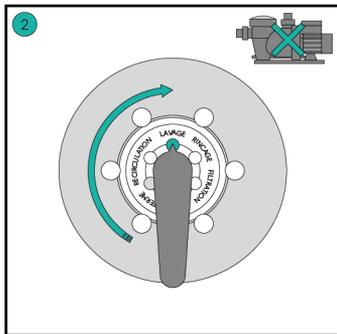
Lors des manipulations de la vanne du filtre, la pompe de votre installation doit être hors tension. Procéder à un cycle de lavage de votre filtre (2-5 min), la vanne en T vers l'égout ouverte (si votre installation en dispose d'une).
