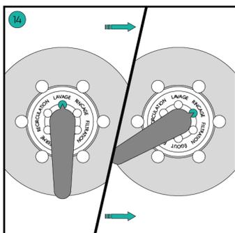
Procéder à un premier lavage et un premier rinçage du filtre (les vannes en T d'entrée et sortie du filtre auront été préalablement réouvertes - pendant ces manipulations la pompe est éteinte.)
