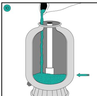
Une fois le sable totalement évacué du filtre, remplir le filtre avec les SB ROUGES fournis en les vidant de façon à enrober les crépines.
