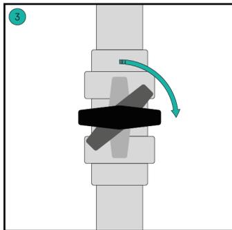
Pompe arrêtée, fermer les vannes en T d'entrée et sortie du filtre. Mettre la vanne du filtre en position Fermée (ou Arrêt).
